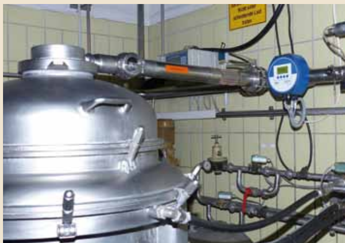
Beim Abschießen der Hefezellen und anderer Eiweiß-Trubstoffe im Separator kommt etwas Sauerstoff ins Bier – das wird exakt gemessen
