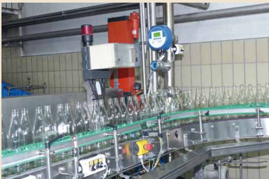
Installation des Inline-Messgeräts direkt vor dem Füller
